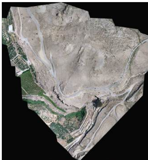
Workflow con Agisoft Metashape: ortofoto georeferenziata
