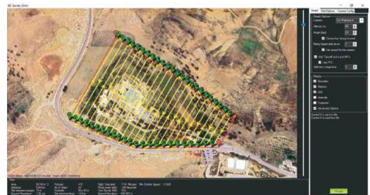
Impostazione del piano di volo con Mission Planner
